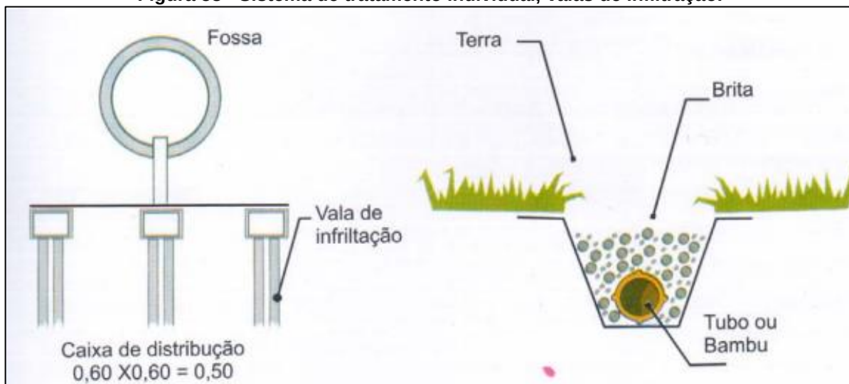
Figura 58 - Sistema de tratamento individual, valas de infiltração.
